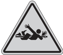
Body Entanglement Hazard
